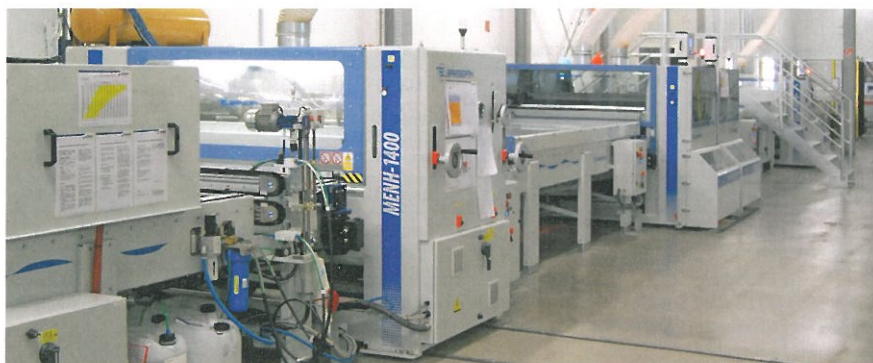
Der erste Schenkel der U-förmigen Anlage, von links: Aufwärmstation, Reinigung und HotCoating-Walzmaschine. Es folgen Lackwalzmaschinen mit UV-Härtern. Investitionsvolumen: 3 Millionen Euro
