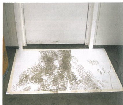
Eine klebrige weiße Fußmatte vor der mehrfach gegen Staub gekapselten Decklackstation
